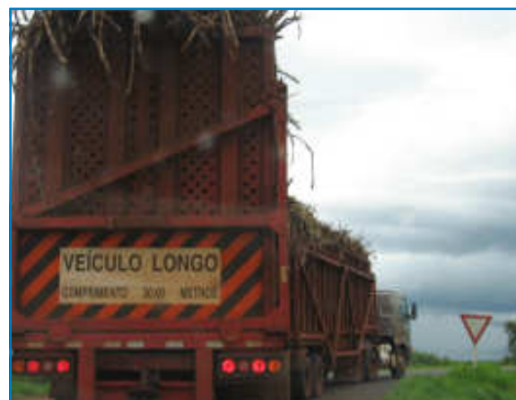
Rodovia MG 255, Triângulo Mineiro (04/12/2006): Excesso de peso dos caminhões carregados com cana-de-açúcar deteriora a malha rodoviária.
